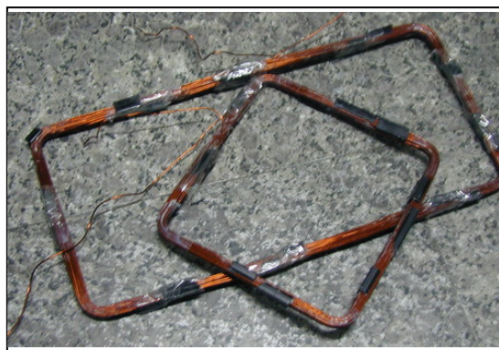
图 3.23 补偿地磁及杂散磁场的线圈
