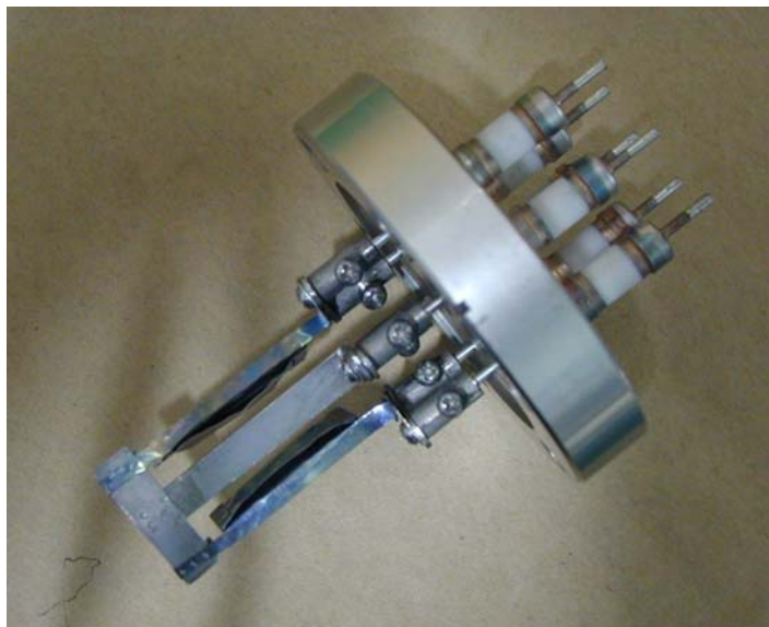
图 3.17 钾原子释放剂样舟照片。在一个法兰上安装有两个样舟，它们有一个公共电极。
