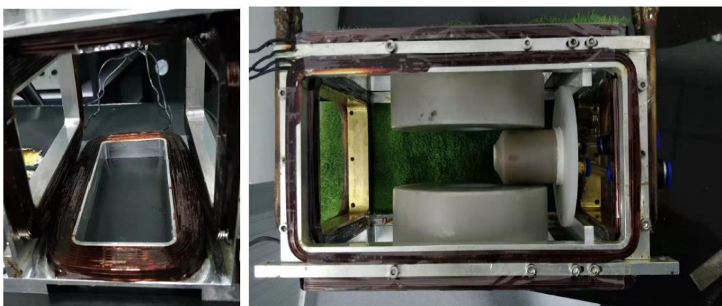
图 2.22 实验线圈系统实物图。左图为 2D 磁光阱线圈，右图为 3D 磁光阱四极线圈、Ioffe 线圈、用作转移原子的线圈、以及 Ioffe 线圈。
