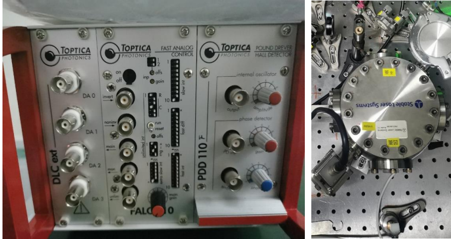
图 2.6 小型伺服系统与超稳定 F-P 腔体实物图
