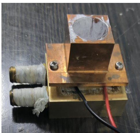
图 2.5 回收铷源半导体制冷片
