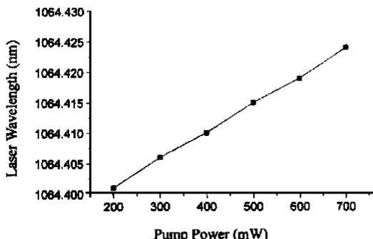
图 6 不同泵浦功率对应的激光输出波长
