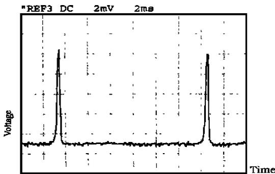
图 3 基波通过扫描 F-P 共焦腔的透射曲线
