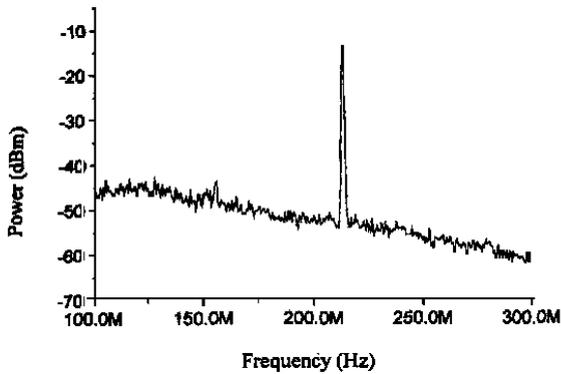
图 7 两台单频激光器 1 和 2 的拍频信号
