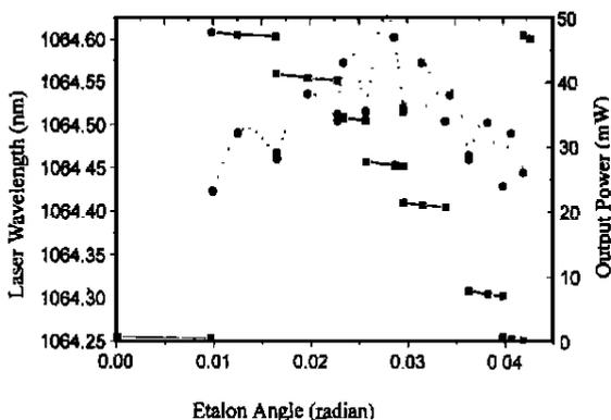
图 5 不同标准具倾斜角所对应的激光输出波长和功率 . 小黑方块为实验测得的激光波长 ,小圆点为激光输出功率 ,泵浦功率为 300mW
