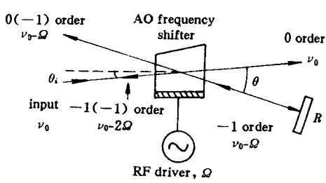
图 1 往返两次通过的声光频移器示意图
