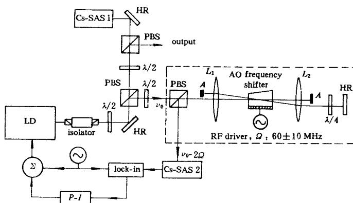
图 3 LD 偏频锁定实验装置示意图
