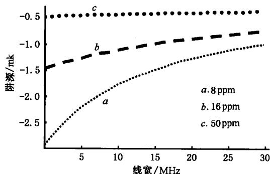
图 6 偶极阱深和线宽的关系 ( $P_{\text{in}} = 1\mu\text{W}$ )
