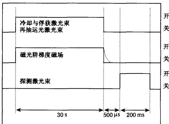
图1 磁光阱测试系统时序图。磁光阱装载30s后,关断冷却与俘获光和再抽运光激光束(典型关断时间小于1 $\mu$ s),同时关断磁光阱的四极磁场(典型关断时间小于450 $\mu$ s),在冷原子云自由膨胀500 $\mu$ s后,打开探测激光束测量冷原子对探测光的吸收
