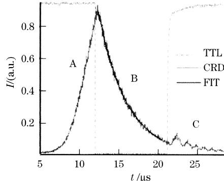
图 2 实验中观测到的透射的腔衰荡信号。其中,TTL 为迟滞比较电路输出控制声光调制器的触发信号、CRD 为透射的腔衰荡信号、FIT 为指数衰减理论拟合结果
