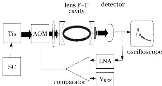
图 1 实验装置图: SC, 激光频率扫描控制系统; TiS, 钛宝石单模单频激光器; AOM, 声光调制器; LNA, 低噪声前置放大器; V<sub>REF</sub>, 参考电压
