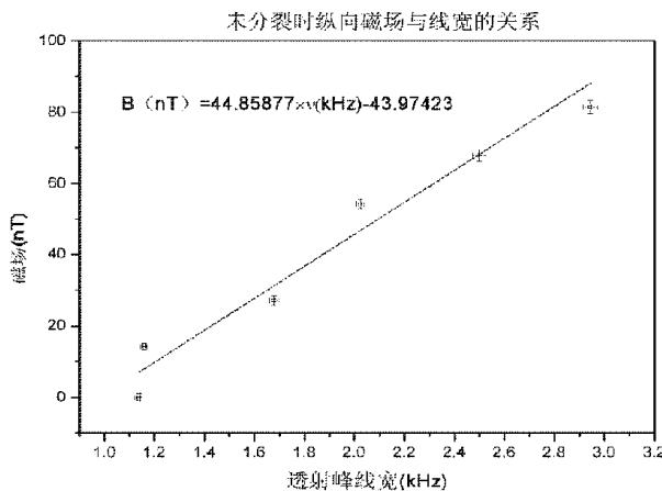
图 5 磁场较弱时, 单峰的 CPT 线宽与磁场的关系
