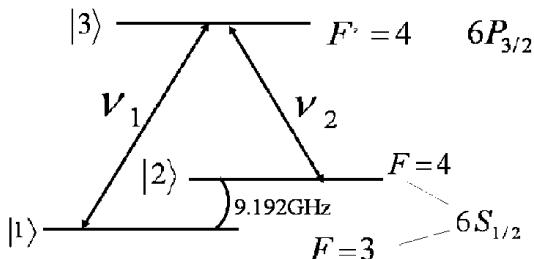
图 1 Cs 原子型三能级系统
