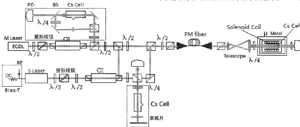
图 2 CPT Cs 原子磁强计实验装置图
