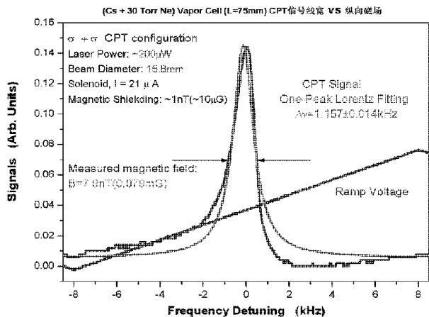
图 4 轴向弱磁场中的 CPT 信号
