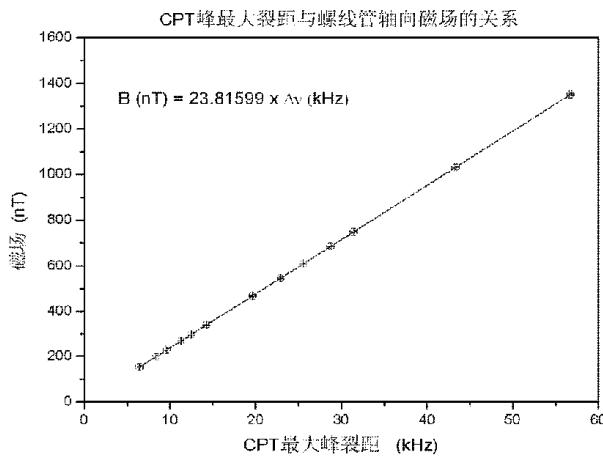
图 6 中等强度磁场中 CPT 峰最大裂距与磁场的关系
