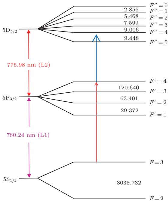
图1 (网刊彩色)  $^{85}\text{Rb}$  原子相关超精细能级图<sup>[3,4]</sup>, 能级结构之间的数字代表超精细分裂, 单位为 MHz
