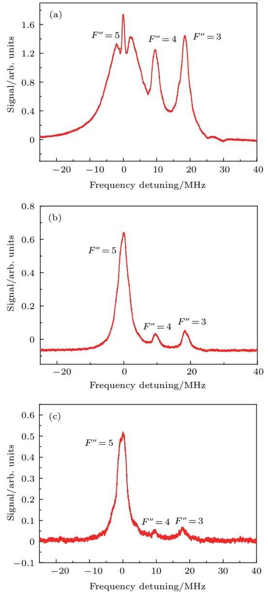
图 3 (网刊彩色) EIT 谱线随耦合光功率变化. 探测光功率为  $20 \mu\text{W}$ , 耦合光分别为 (a)  $2.7 \text{ mW}$ , (b)  $100 \mu\text{W}$ , (c)  $50 \mu\text{W}$ .
