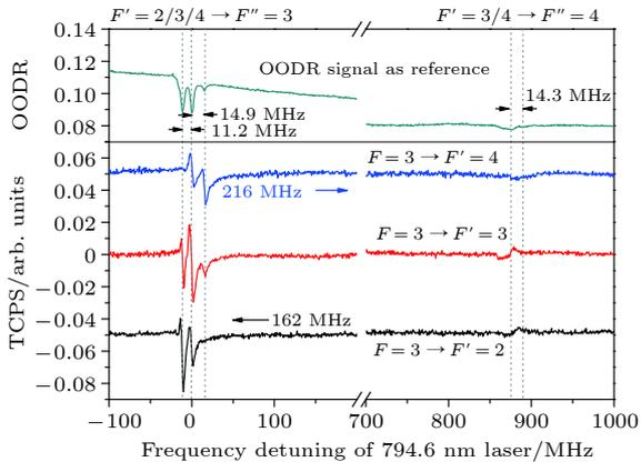
图 4 反向传输实验构型, 852.3 nm 抽运光频率锁于  $6S_{1/2}$  ( $F = 3$ ) $\rightarrow 6P_{3/2}$  ( $F' = 2, 3, 4$ ) 时, 794.6 nm 激光作为探测光的 TCPS
