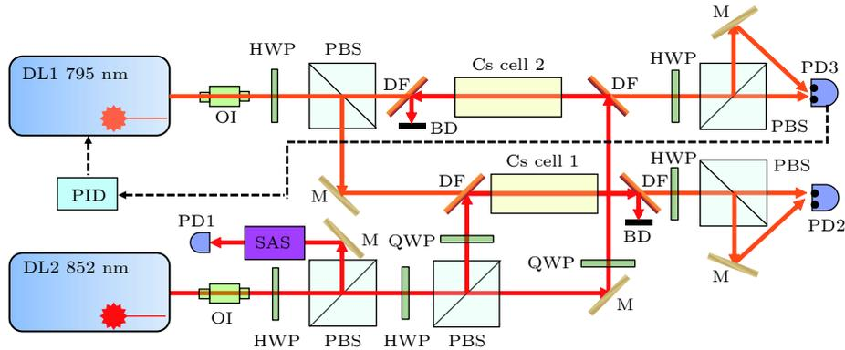
图 2 实验装置示意图 DL 为 852 和 795 nm 光栅外腔反馈半导体激光器, OI 为光隔离器, SAS 为饱和吸收光谱装置, PID 为比例积分微分放大器, HWP 为  $1/2$  波片, QWP 为  $1/4$  波片, M 为  $45^\circ$  高反镜, PBS 为立方偏振分光棱镜, Cs Cell 为  $25 \text{ mm} \times 50 \text{ mm}$  铯原子泡, DF 为双色镜, BD 为挡光板, PD 为光电探测器
