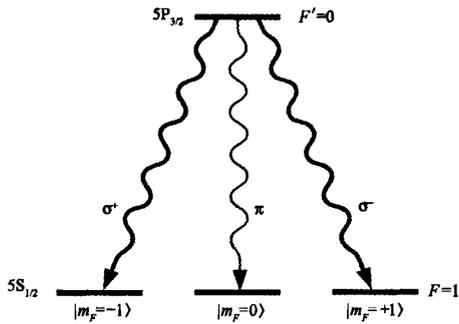
图7 文献[34]中与单原子-单光子纠缠态产生相关的<sup>87</sup>Rb原子能级
