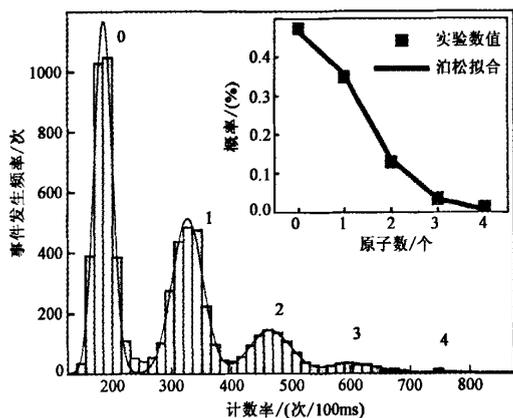
图2 不同计数率下的原子荧光计数的事件数目统计<sup>[7]</sup>. 内嵌小图显示的是对应于磁光阱中获得确定数目原子的概率
