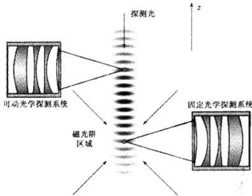
图4 原子的“光学传送带”:将磁光阱中的单原子载入一维光学晶格,使光学晶格沿轴向运动起来,实现原子的输运<sup>[17]</sup>
