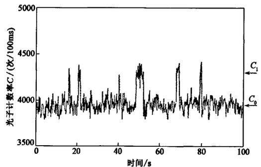
图1 在背景铯原子密度很低的情况下,磁光阱中原子的荧光计数率随时间的变化<sup>[5]</sup>(台阶状的信号表示单个铯原子到达和离开磁光阱的情形; $C_1$  箭头所指的荧光计数率水平表示磁光阱中捕获单个原子的情形; $C_0$  箭头所指的荧光计数率水平是背景光子计数,表示磁光阱中没有原子的情形)
