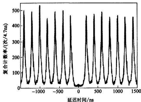
图6 单光子源在不同延迟时间下HBT实验的强度关联<sup>[31]</sup>.零延迟对应的复合计数率为零,说明系统辐射的是单光子.其余峰值间的时间间隔对应于激发脉冲周期200ns(重复频率为5MHz)
