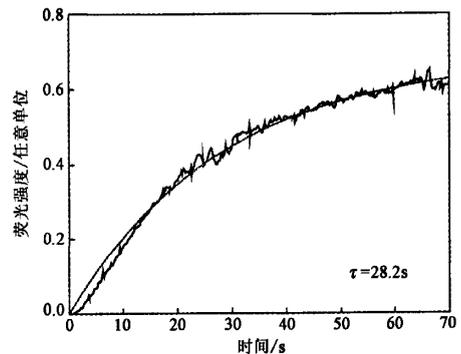
图 9 我们的常规铯原子磁光阱典型的装载曲线(阱中冷原子的典型寿命约 28s)
