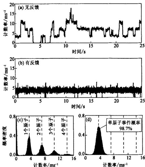
图3 文献[11]中铬原子磁光阱中的荧光信号 (a) 关断反馈时荧光计数率随时间的变化; (b) 打开反馈时荧光计数率随时间的变化; (c), (d) 分别是对应于(a), (b) 情形下不同计数率(对应于原子数)的概率密度
