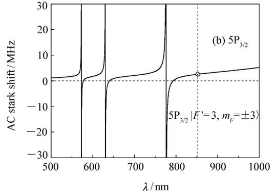
图 6  $^{87}\text{Rb}$  原子  $5S_{1/2} |F=2, m_F = \pm 2\rangle$  和  $5P_{3/2} |F'=3, m_F = \pm 3\rangle$  态的 AC Stark 频移
