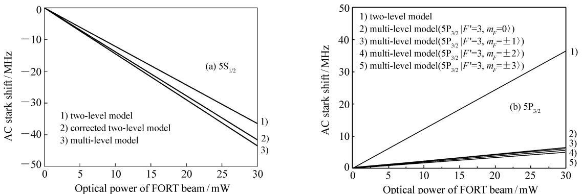
图 4 采用不同模型对  $852 \text{ nm}$  线偏振光聚焦到腰斑半径为  $2.1 \mu\text{m}$  的偶极阱中  $^{87}\text{Rb}$  原子  $5S_{1/2}|F=2, m_F = \pm 2\rangle$  和  $5P_{3/2}|F'=3\rangle$  各个 Zeeman 子能级的 AC Stark 频移的计算结果
