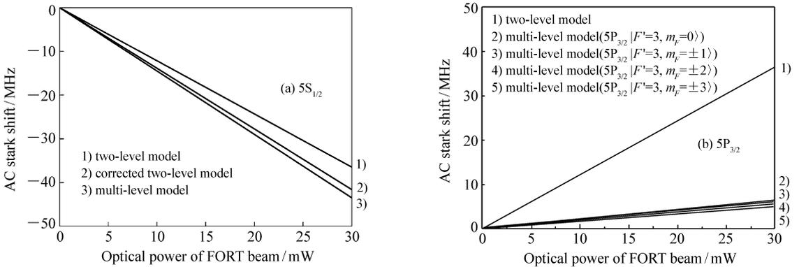
图 4 采用不同模型对  $852 \text{ nm}$  线偏振光聚焦到腰斑半径为  $2.1 \mu\text{m}$  的偶极阱中<sup>87</sup>Rb 原子  $5S_{1/2} |F=2, m_F = \pm 2\rangle$  和  $5P_{3/2} F'=3$  各个 Zeeman 子能级的 AC Stark 频移的计算结果
