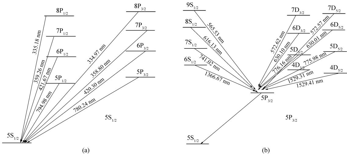
图 3 计算中考虑的 $^{87}\text{Rb}$ 原子涉及  $5S_{1/2}$  态和  $5P_{3/2}$  态的偶极跃迁
