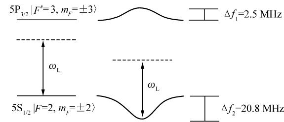
图5 功率为15 mW的852 nm线偏振高斯光束聚焦到腰斑半径为 $2.1\text{ }\mu\text{m}$ 的偶极阱中, $^{87}\text{Rb}$ 原子 $5S_{1/2} |F=2, m_F=\pm 2\rangle$ 和 $5P_{3/2} |F'=3, m_F=\pm 3\rangle$ 态的AC Stark频移
