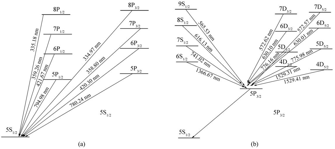
图 3 计算中考虑的<sup>87</sup>Rb 原子涉及  $5S_{1/2}$  态和  $5P_{3/2}$  态的偶极跃迁
