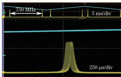
图10 锁定15 min内基频光频率漂移
