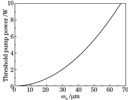
图1 抽运阈值随着激光晶体处腰斑半径的变化曲线
