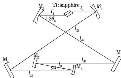
图2 激光谐振腔结构
