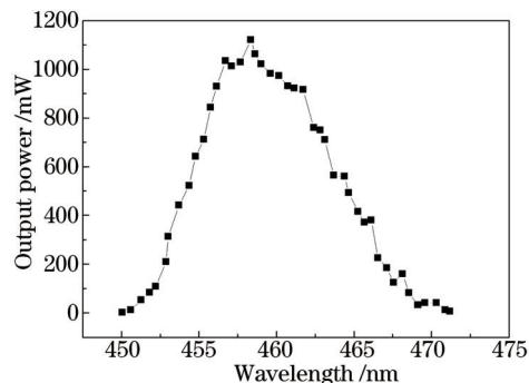
图 9 蓝光输出功率随波长的变化曲线
