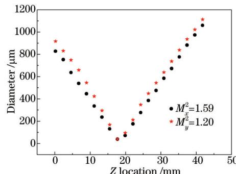
图 8 蓝光  $M^2$  光束质量因子Fig.8 Measured  $M^2$  values for blue laser
