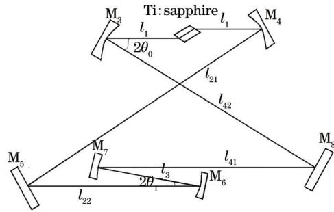
图2 激光谐振腔结构
